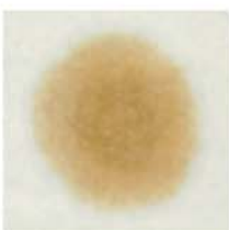
So sieht das Testergebnis eines noch intakten Motoröls aus einem Benziner aus.
