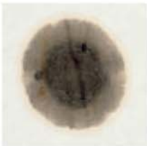
Mittelprächtigtes Öl eines Dieselmotors. Der zweite Ring bildet einen deutlichen Kontrast zum inneren Kreis.
