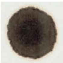
Dieses Öl aus einem Diesel ist wechselreif. Der deutlich erkennbare Zackenkreis verrät, dass sich Kondenswasser im Öl befindet.
